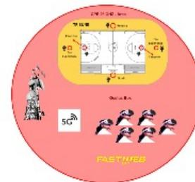
All'interno del Forum saranno installate **due antenne in modalità 5G SA mmW** utili a fornire la connettività alle **telecamere Insta360 Pro2** e ai **Visori Oculus** delle postazioni nel palazzetto (Totem)
